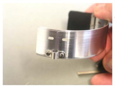
Die Haltelaschen werden mit je 2 Schrauben Din 7985 M2x5 und Mutter M2 befestigt . Schrauben nicht festziehen .
