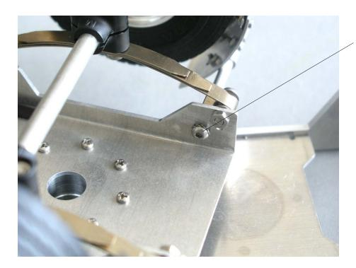
Schraube Din 7380 M3x6 mit Zahnscheibe Din 6798-3,2
