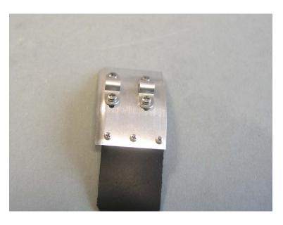
Die Haltelaschen werden mit je 2 Schrauben Din 7985 M2x5 und Mutter M2 befestigt . Schrauben nicht festziehen .
