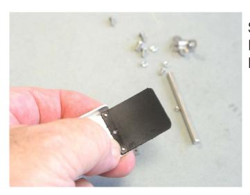
Stecken Sie bitte 2 Schrauben Din 7985 M1,6 in die Löcher wie im Bild sichtbar. Der Gummi-Lappen wird darauf gelegt .
