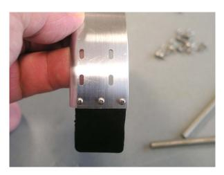
Setzen Sie bitte die 3.Schraube ein . Richten Sie bitte das Gummi so aus , dass es gerade am Kotflügel hängt. Dann können die Schrauben festgezogen werden.
