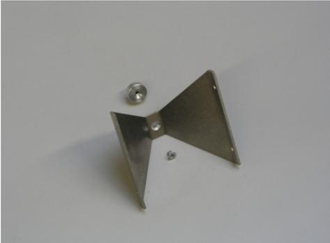
Auf das Abdeckblech (C) wird mit einer Schraube DIN-965 M3x4mm die Greiferaufnahme montiert.
