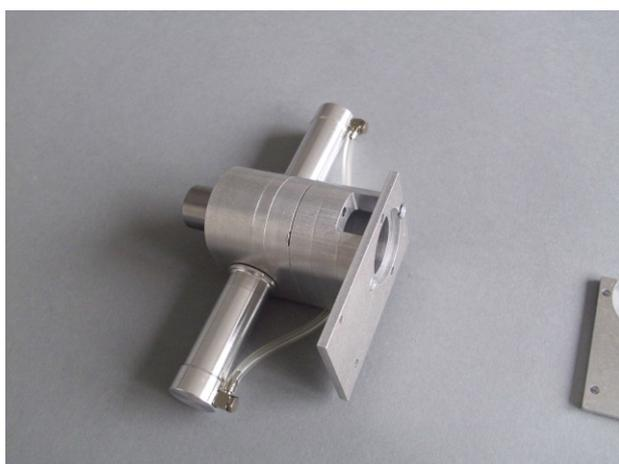
Das Kranbefestigungsblech wird mit 2 Schrauben Din 965 M3x30 mit der Kranerhöhung am Schwenkzylinder verschraubt .
