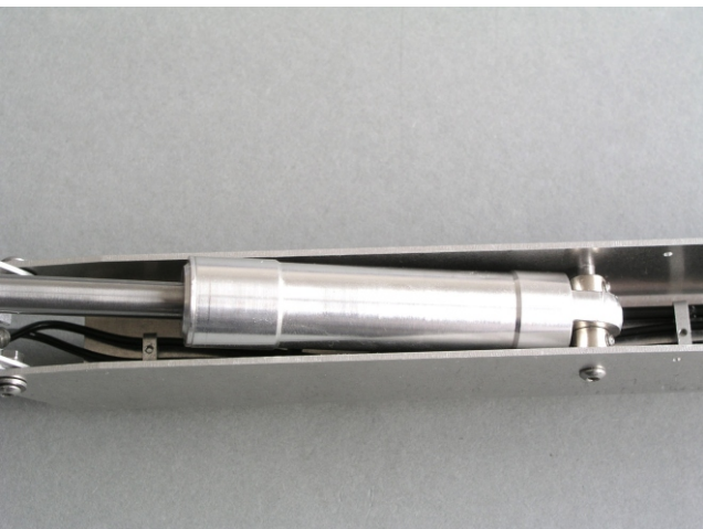
Der eingeklappte Zylinder darf die Schläuche nicht knicken .
