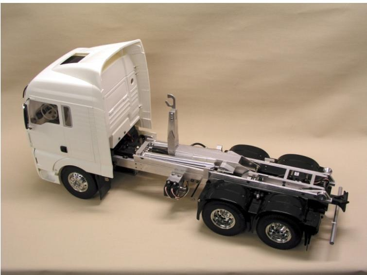
Für die Befestigung des Steuerventils sind am Rahmen ebenfalls bereits Bohrungen vorhanden. Montiert wird es mit 2 Schrauben M3x4.
