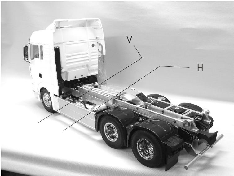
Bauen Sie das Fahrzeug zunächst nach der Tamiyaanleitung auf oder um. Verwenden Sie bitte die Rahmen aus diesem Set. Es sind alle Löcher und Gewinde wie im Originalrahmen vorhanden. Orientieren Sie sich im Bereich (V) von vorn und im Bereich (H) von hinten. Die Querträger (Q14) und (F1) werden nicht eingebaut. Der Batteriehalter (D6) wird ebenfalls nicht benötigt.
