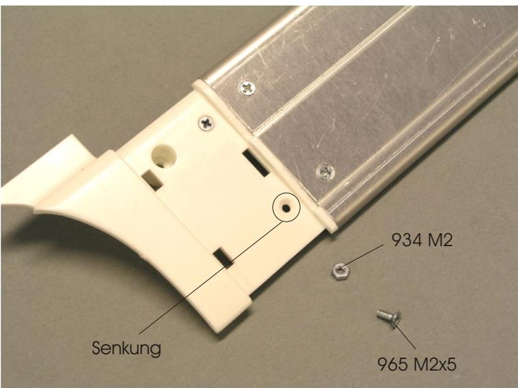
Jetzt setzen Sie die Teile bitte wieder zusammen, richten sie aus und verschrauben sie mit 2 Schrauben Din 965 M2x5 und 2 Muttern Din 934 M2.
