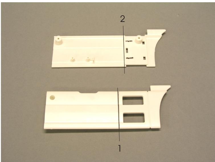
Da unser Rahmen gegenüber dem Original passend verlängert ist, müssen die Seitenverkleidungen auch angepasst werden. Bitte trennen Sie die rechte Originalverkleidung genau in der Fuge (1) ab. Auf der Rückseite der linken Originalverkleidung sehen Sie die Erhöhung für die MAN Blende (W4). Trennen Sie das Teil bitte so ab das diese Erhöhung (Kante) gerade stehen bleibt (2).
