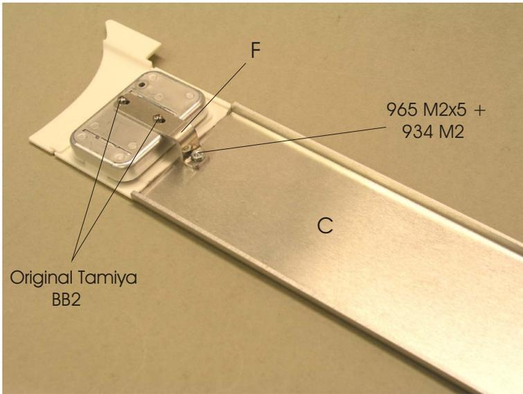
Die rechte Seitenverkleidung (C) wird mit einer Schraube Din 965 M2x5 und Mutter M2 mit dem Halter (F) verbunden. Die ganze Einheit wird mit unter die original Verschraubung (BB2) der Trittstufen gelegt, ausgerichtet und festgezogen.
