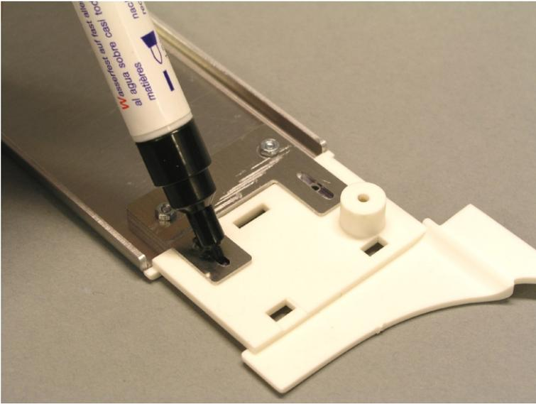
Legen Sie jetzt das abgetrennte linke Seitenteil, wie im Bild gezeigt, an und richten es aus. Mit einem Faserschreiber markieren Sie bitte die Lage der Langlöcher.
