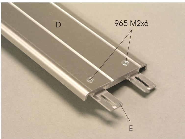
Verbinden Sie die Teile (D) und (E) ,wie im Bild zu sehen, mit 2 Schrauben Din 965 M2x6 und den Muttern M2. Achten Sie bitte auf die Lage des Absatzes.
