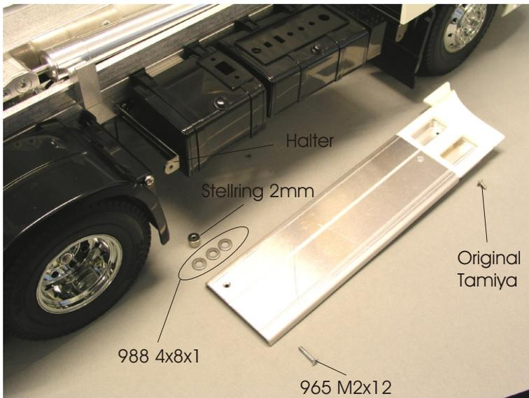
Die zusammen gefügten Seitenteile werden nun jeweils vorne mit der Original Tamiya Schraube befestigt. Hinten benutzen Sie bitte die Schraube Din 965 M2x12. Als Abstandshalter fädeln Sie zwischen die Abdeckung und dem Halter jeweils 3 U-Scheiben Din 988 4x8x1 und einen Stellring.
