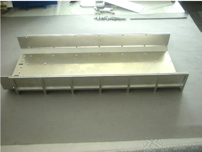
Nach der Anpassung wird das Blech mit Schrauben Din965 M2\*4 an den Gittern festgeschraubt.
