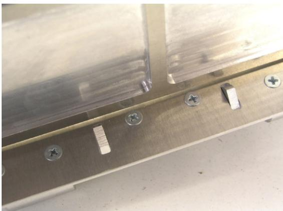
Der Verschlusshalter wird mit den 2 Schrauben Din 965 M3\*4 montiert.
