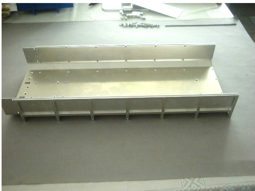
In die zusammengesteckte Gitterkonstruktion wird das Muldenblech eingelegt. Prüfen Sie bitte ob alle Löcher im Bodengitter und in den Seitenteilen passen. Sollte das nicht der Fall sein, muß das Muldenblech nachgebogen werden. Vorsicht, Fräs- und Schnittkanten können sehr scharf sein. (Schnittverletzungen).
