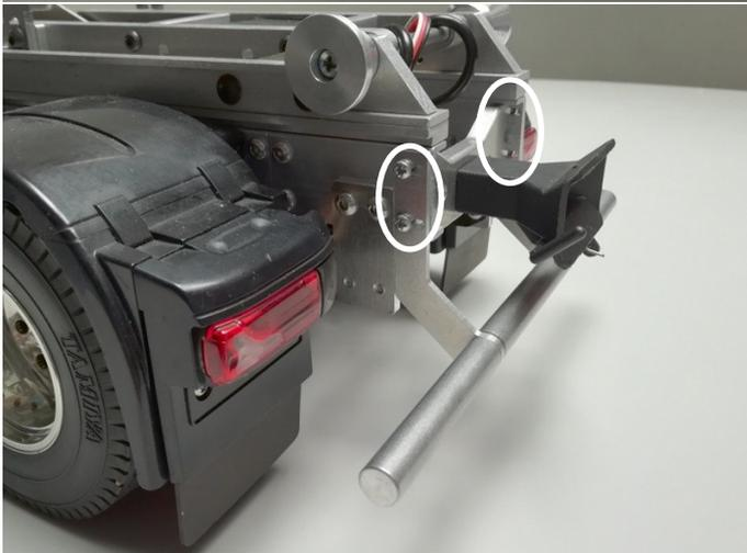
Die Position der Rahmenabschluss-Traverse kann in den Langlöchern eingestellt werden. Dies kann je nach verwendetem Zugmaul / Anhängerkupplung notwendig sein (Siehe Bild unten)
