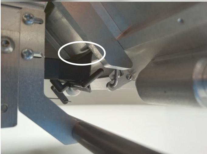
Mit dem zu den Deichseln unserer Anhänger passenden Zugmaul von WEDICO / THICON muß die Rahmenabschluss-Traverse innerhalb der Langlöcher ganz nach innen geschoben werden, damit die Anhängerkupplung nicht zu weit heraussteht. Beim Kippen des Abroll-Aufbaus kann es allerdings trotzdem eng werden.
