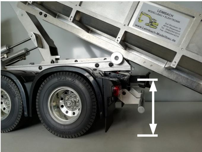
Die Befestigungs-Höhe für die Anhängerkupplung in der nach unten gekröpften Rahmenabschluss-Traverse (E) ist gleich mit der Höhe, die auch die abfallende original Traverse einer TAMIYA Sattelzugmaschine hat, welche sonst ohne diesen Umbausatz verwendet wird.
