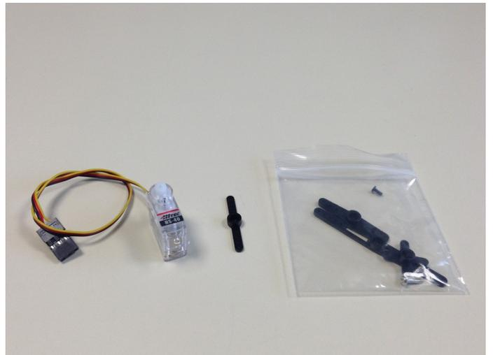
Kürzen Sie bitte den Servo-Hebel auf beiden Seiten z.B. mit einem Seitenschneider, wie in den Bildern unten gezeigt.
