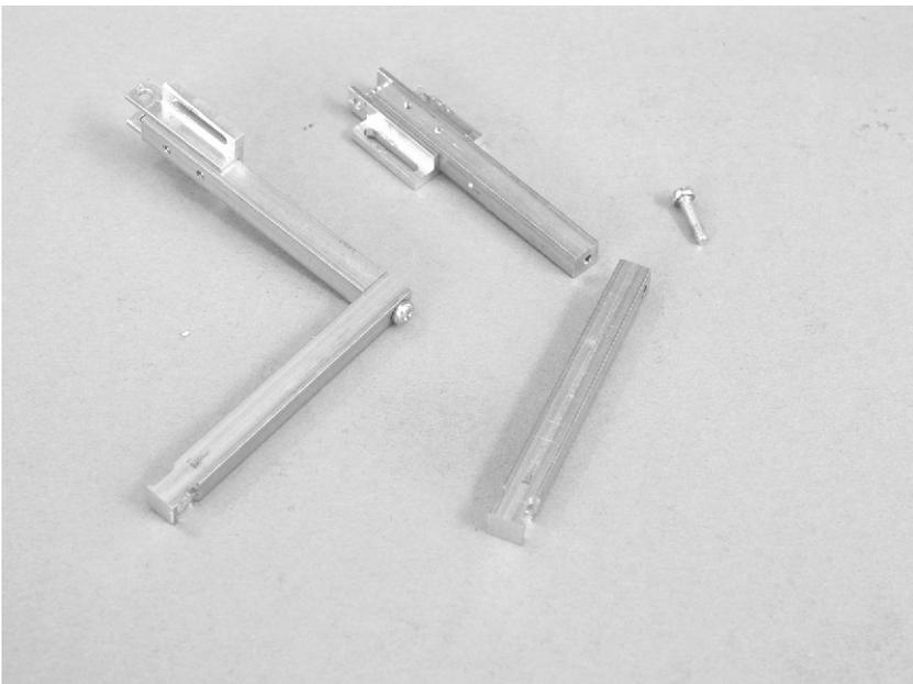
Mit einer Schraube Din 7985 M2x8 wird Tankhalter Teil 3 an Teil 2 angeschraubt .
