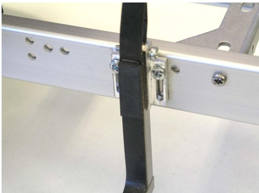
Die abgeschnittenen Stücke des Gummi-Streifens werden oben am Halter ( siehe Bild ) angeklebt .
