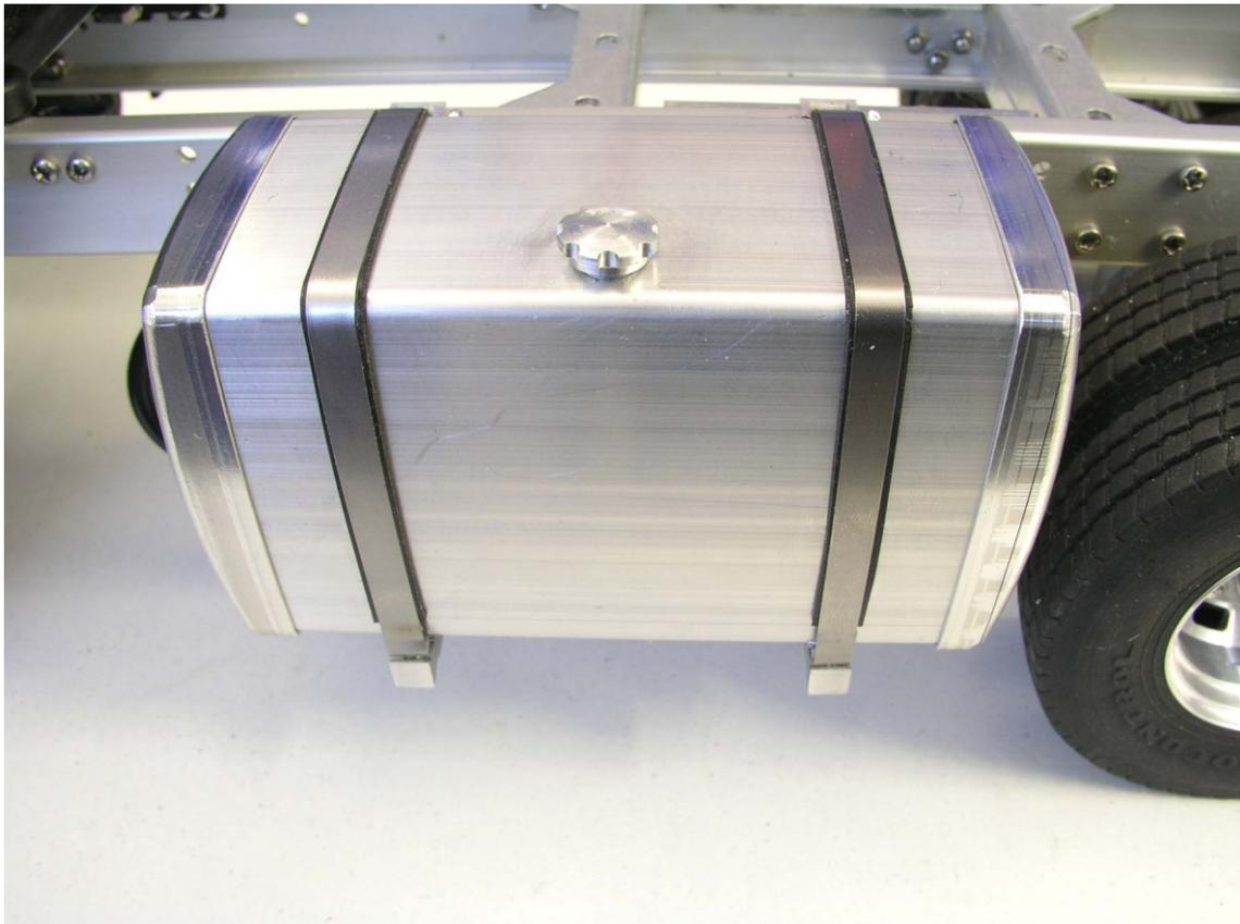
Dann kann die Pumpe auf die Halter gestellt werden und nach Ausrichten der Gummi-Unterlagen mit den Spannbändern befestigt werden . Die Spannbänder sind unter dem Halter 3 mit je einer Mutter Din 934 M2 leicht gespannt .
