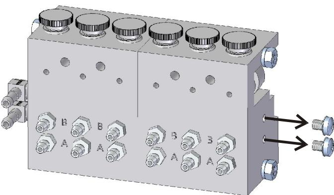
Eine weitere Möglichkeit (bei neueren Versionen unserer Ventile) die Ventile untereinander zu verbinden ist das rückseitige Einschrauben von zusätzlichen Einschraubnippeln ( siehe dargestelltes Beispiel eines OH506A + OH502 )
