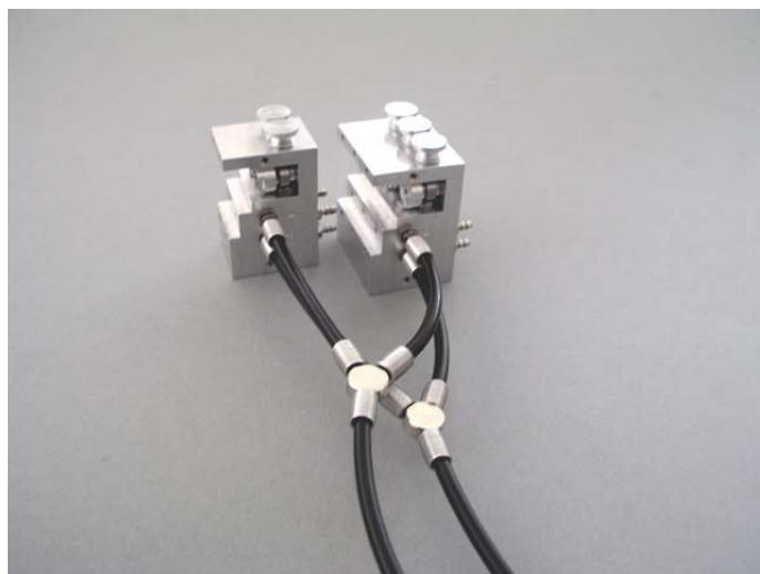
Eine Möglichkeit dies zu tun ist die Verwendung von (separat zu erwerbenden) T- oder Y- Verbindern, Sicherungshülsen und Schlauchleitungen 4mm. Damit werden dann jeweils die zwei Anschlüsse "P" und die zwei Anschlüsse "T" der Steuerventile miteinander und dann mit der Pumpe verbunden.
