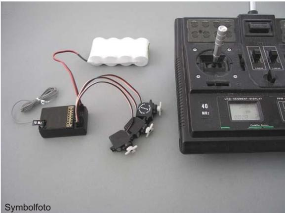
Durch den Transport oder das Abschrauben des Servo-Kreuz steht das Servo vor dem Einbau nicht mehr in Mittelstellung / Neutralstellung, Schließen Sie es daher **vor dem Einbau** in das Ventil an den jeweiligen Kanal des Empfängers Ihrer Fernsteuerung an, mit dem Sie später die Hydraulik-Funktion steuern möchten.
