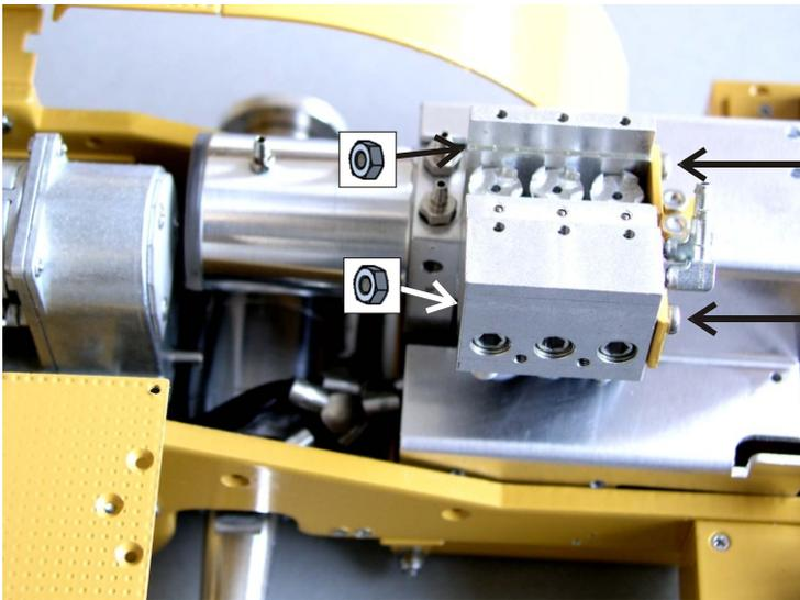
Das Ventil wird abweichend von der WEDICO Bauanleitung mit den beiliegenden Schrauben DIN-7985 M3 x 40mm und Muttern DIN-934 M3 an dem Haltewinkel befestigt.
