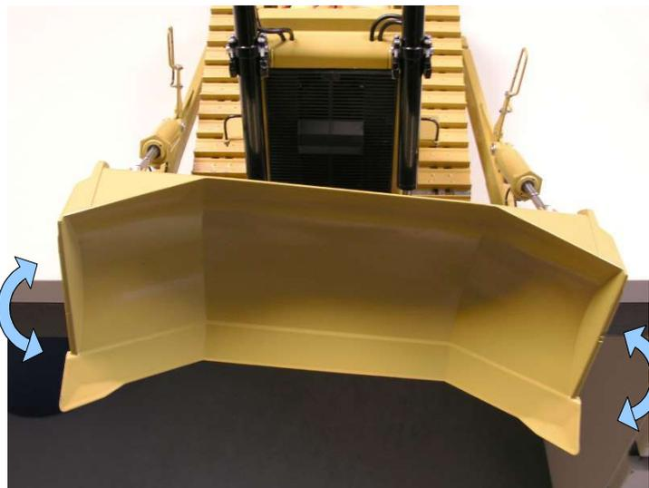
Wenn Sie die rein elektrische Inbetriebnahme nach der beiliegenden Anleitung durchgeführt und die Servos, wie beschrieben, in das Ventil eingebaut haben, sollten Sie noch einmal alles zusammen (Hydraulik mit Elektrik) durchtesten und falls notwendig die Feinabstimmung der Trimmung Vornehmen.
