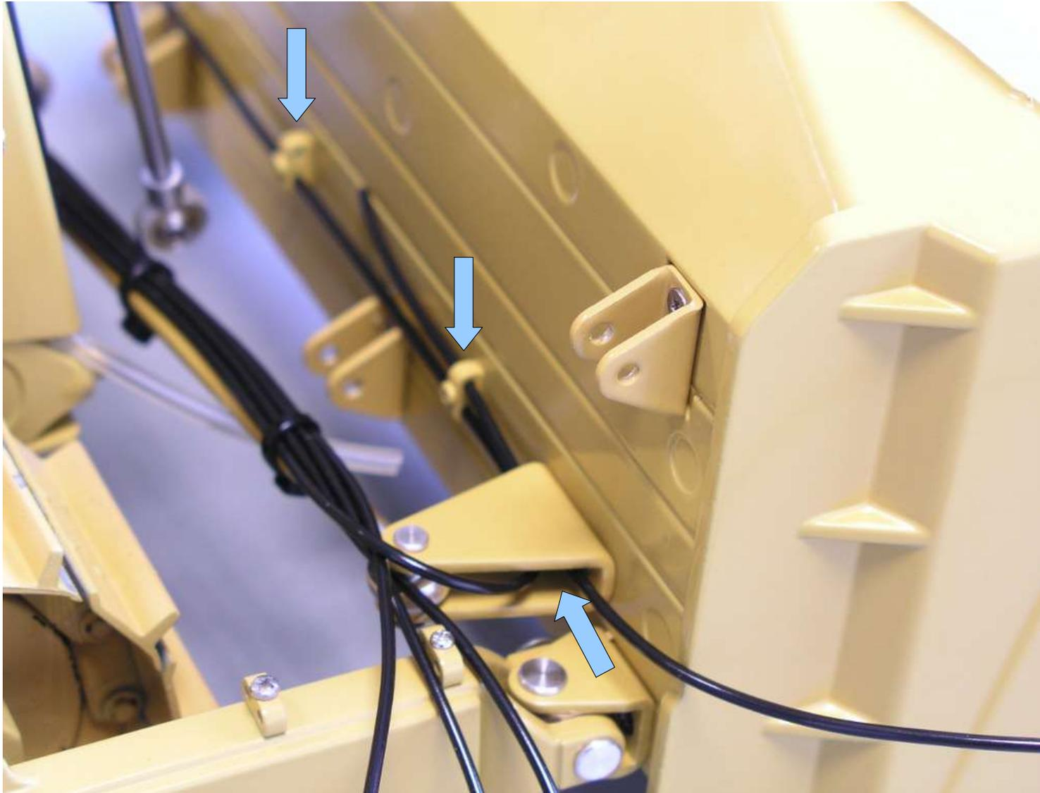
Führen Sie die zwei Schlauchenden der aufgetrennten Schlaufe durch die Schlauchhalter am Planierschild, wie im Bild zu sehen.
