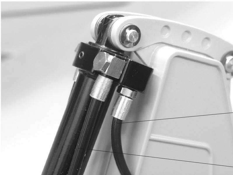
Der Schlauchadapter wird auf das Fußteil des Löffelzylinders geschoben und mit der Madenschraube geklemmt .
