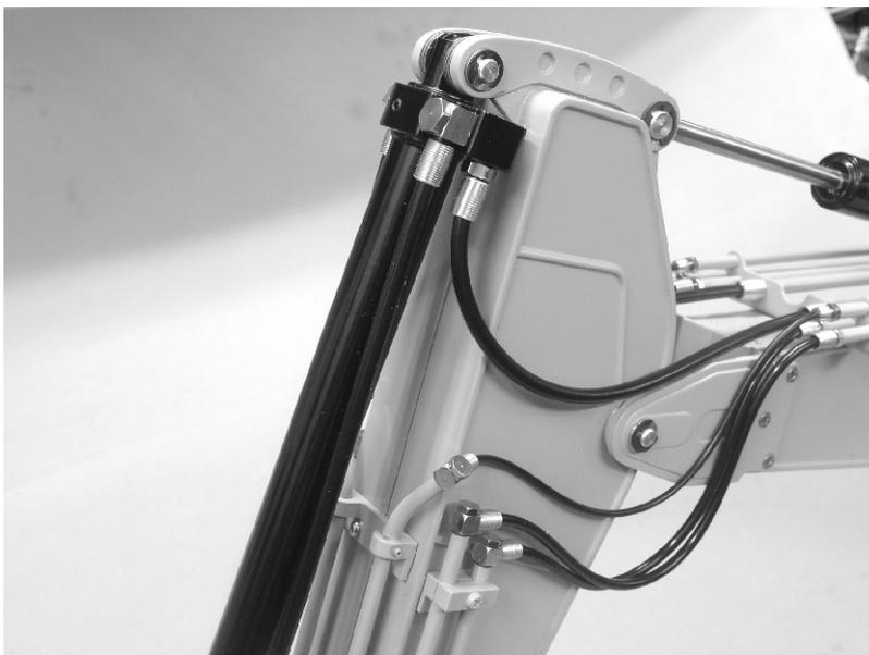
Durch den Schlauchadapter ist eine schönere Schlauch-führung möglich .
