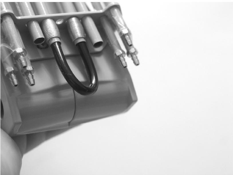
In die Rohre werden dann die Nippel mit Hydraulikdichtung oder leichter Schraubensicherung eingesetzt .
