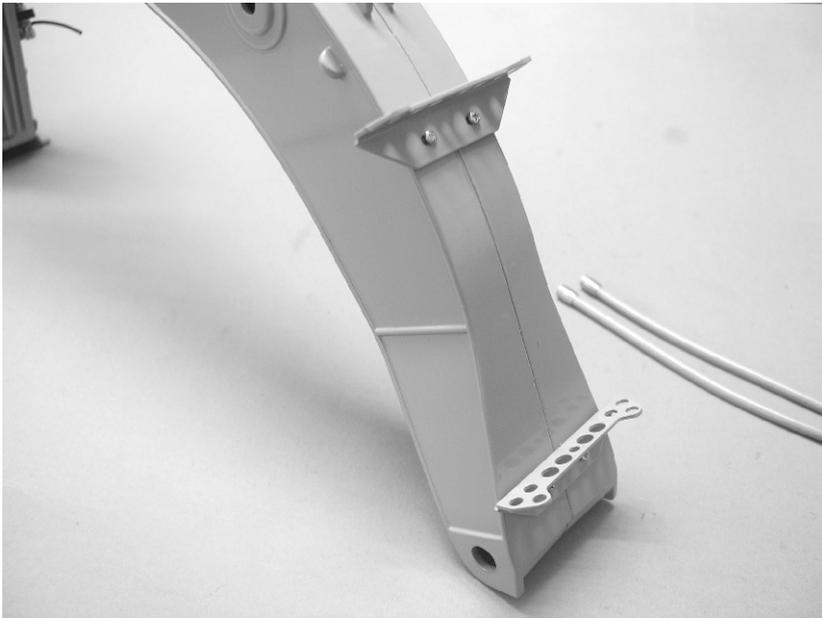
Montieren Sie bitte die Alu-Winkel wie im Bild ersichtlich mit je 2 Schrauben Din 7985 M2x6
