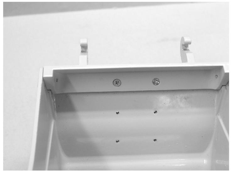
Die Innenbefestigung erfolgt mit 2 Schrauben Din 965 M2x5 .
