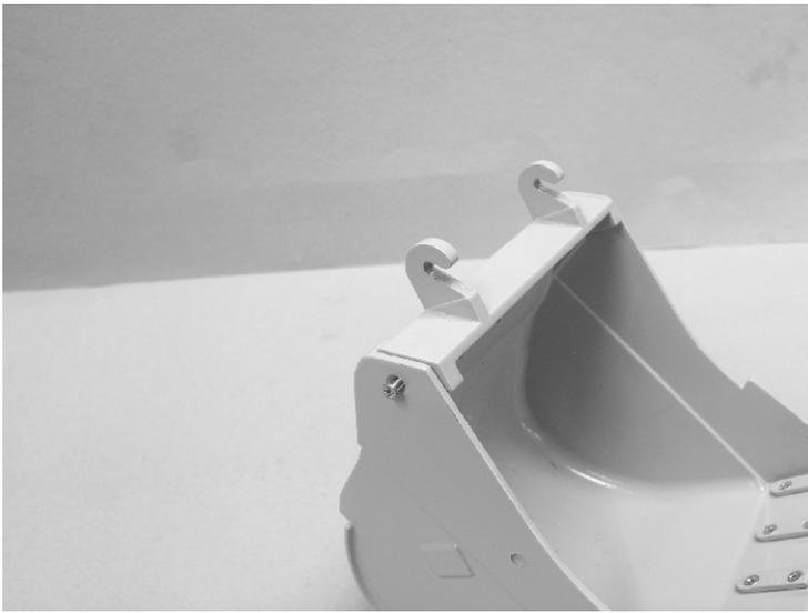
Setzen Sie bitte die Schnellwechsel-Aufnahme in die Schaufel ein . Zur Befestigung werden 2 Schrauben Din 965 M2x8 Va gebraucht .
