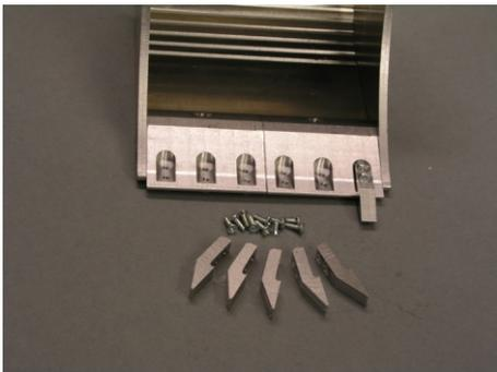
Jetzt werden die Zähne mit Schrauben Din 965 M2x6 angeschraubt.
