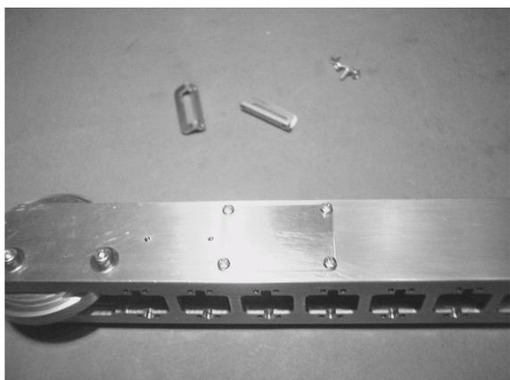
Der Ausschnitt wird mit einer Abdeckplatte und 4 Schrauben M2x4 Din 7985 verschlossen.
