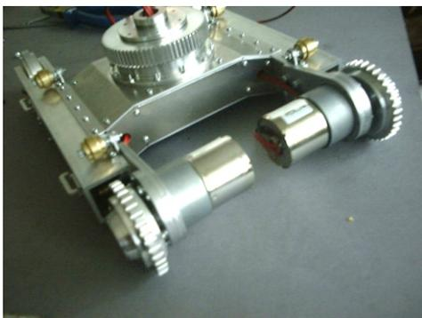
Nach erfolgter Getriebemontage sollte Ihr Unterwagen so aussehen. Nun müssen die Motorkabel angelötet werden.
