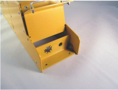
Das Schalterhalteblech wird mit 2 Schrauben M2x5 und M2 Muttern eingebaut.
