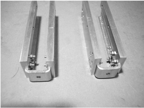
Die Schiebepplatten werden mit je einem kleinen U-Winkel und 8 Schrauben Din 965 M2x8 und Muttern M2 miteinander verbunden.
