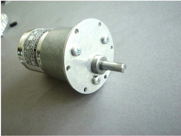
Montieren Sie bitte das Flanschblech mit 3 Schrauben Din 965 M3x6 am Motor. Zwischen Motor und Flanschblech legen Sie bitte je eine U-Scheibe DIN988 3x6x1, da sonst das Getriebe blockieren kann.
