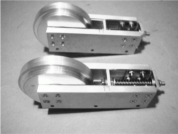
Die zusammengebauten großen Winkel werden mit etwas Fett in die Schiebepplatten eingeschoben. Auf die Gewindestange wird eine U-Scheibe geschoben und eine Stop-Mutter aufgedreht. An ihr wird später die Kettenspannung eingestellt.
