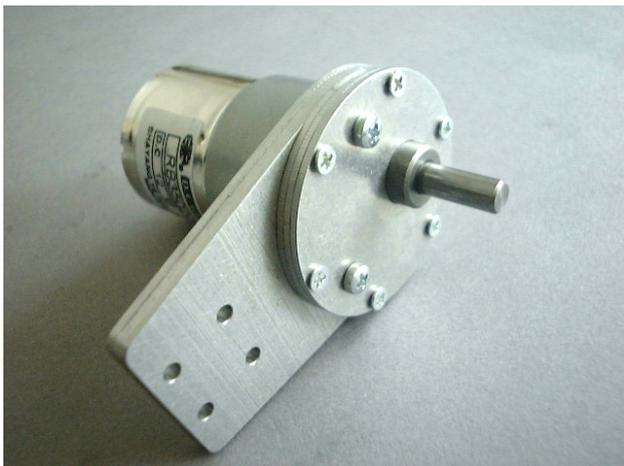
Der Motorträger wird dann mit 6 Schrauben Din 965 M2.5x8 verschraubt.
