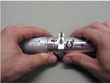
Der Tank der Pumpe wird durch eine Dreh- und Ziehbewegung vom Pumpenkörper abgezogen.
