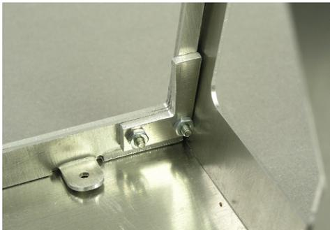
Auf das Kabinen-Innenblech wird zusätzlich der Türanschlag mit 2 Schrauben Din 965 M2x8 und Muttern M2 festgeschraubt .
