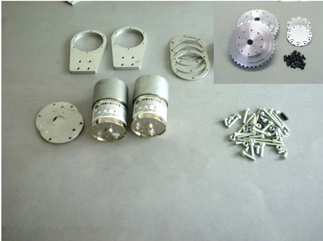
2 Antriebsmotoren mit Getriebe
