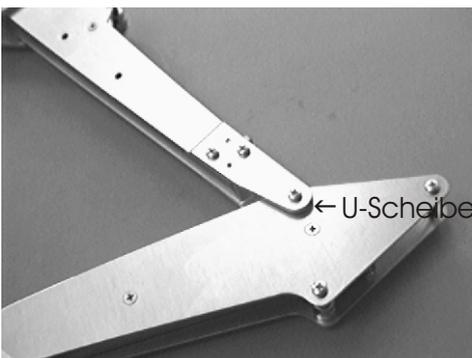
Der zuvor ausgebaute Bolzen wird durch Verstärkungsbleche und 3. Arm geschoben.
