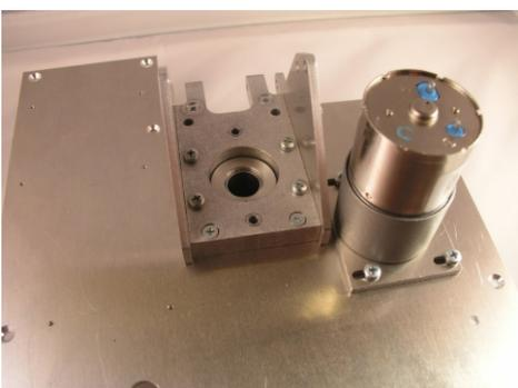
Schieben sie den Schwenkmotor an den Drehkranz.
