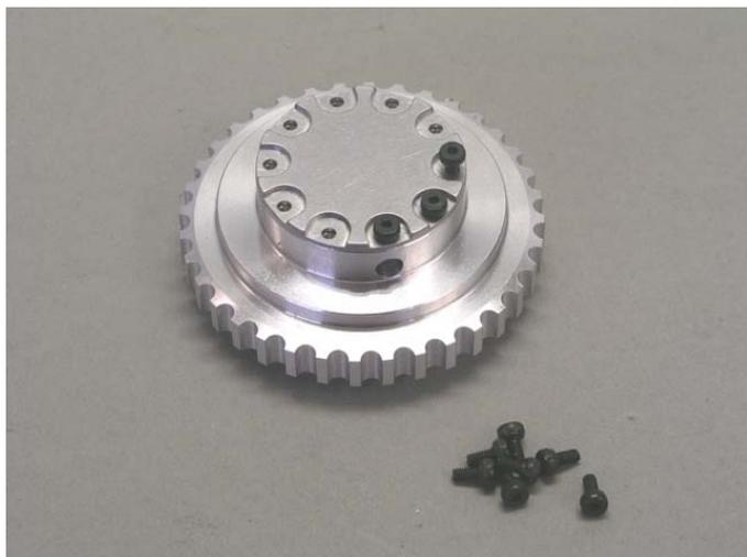
Jetzt werden die Deckel mit je 10 Schrauben DIN 912 M2x4 auf die Antriebsräder geschraubt.
