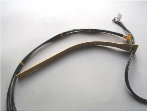
ⓘ Die zwei kürzeren Schlauchstücke werden nicht wie im Bild durch alle drei Schlauchhalter, sondern nur durch die ersten zwei gezogen.
