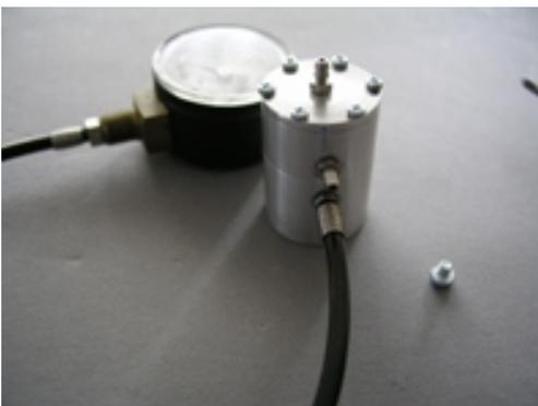
In das Loch wird ein Nippel (im Lieferumfang des Manometers) geschraubt und mit etwas Schlauch (ebenfalls im Manometer-Set enthalten) angeschlossen. Alle Schlauchanschlüsse müssen mit Sicherungshülsen gesichert werden.
