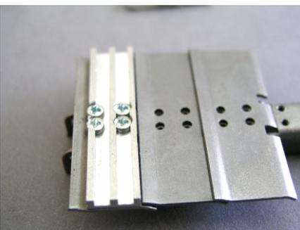
...und dann zusammen mit der Kettenplatte und 4 Schrauben DIN 7985 M2x4 auf dem Kettenwinkel angeschraubt.
