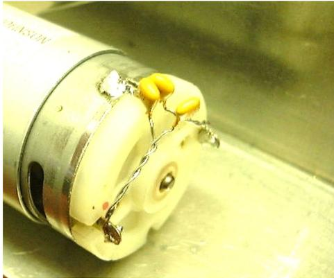
Die Kondensatoren werden dann an dem Motor angelötet. Das Motorgehäuse sollte dazu mit einer Feile leicht angefeilt werden, damit das Lötzinn besser fließt.
