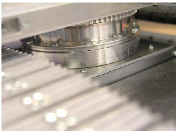
Der in der Stückliste aufgeführte Ring wird später zwischen Unterwagen und Drehkranz mit den beiliegenden Schrauben und den vorhandenen Muttern befestigt .
