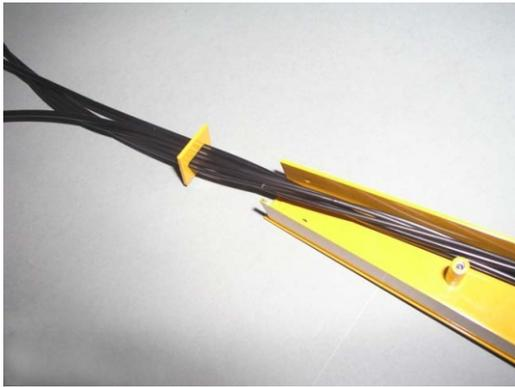
Schieben Sie das Füllblech über die Schlauchenden.
