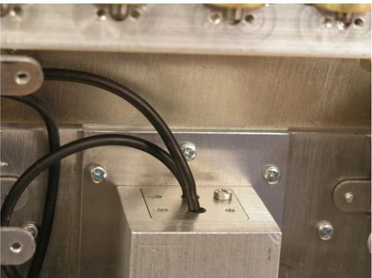
Jetzt kann die Drehdurchführung mit den zuvor nicht eingesetzten 6 Befestigungsschrauben des Drehkranzes montiert werden.
