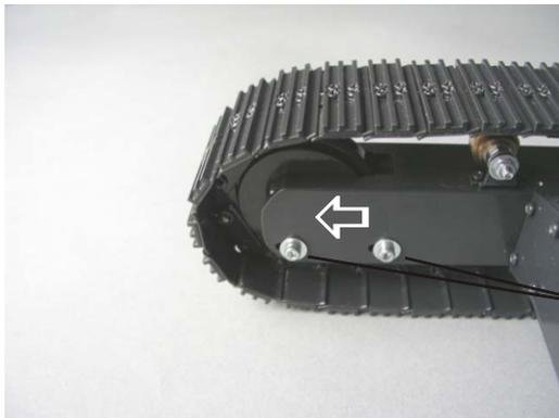
Um die Kettenspannung einzustellen üben Sie bitte etwas Druck auf die gelösten Schrauben des federbelasteten Kettenspanners aus, und ziehen dann zunächst eine Schraube je Seite an. Jetzt können Sie den Kettenspanner loslassen und die verbleibenden zwei Schrauben festziehen.
