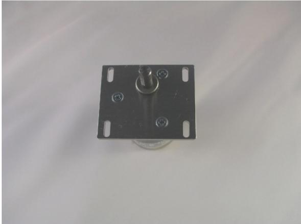
Montieren Sie das Motorhalteblech bitte mit 3 Schrauben Din 965 M3x6 an den Motor.
