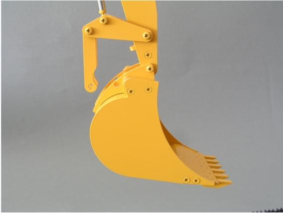
Als erstes wird die Schaufel wie im Bild ersichtlich mit dem im 3. Arm eingebauten Bolzen montiert. Die 2U-Scheiben 4x8x1 Din 988 sollen zwischen den Halbleichen der Schaufel und dem 3.Arm eingebaut werden.
