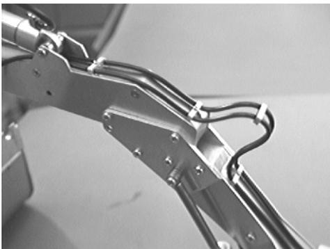
Am Übergang vom 1. zum 2. Arm sollte eine Schlaufe gelegt werden. Damit die Schlauchverlegung in der Schlaufe sauber aussieht, ist dort ein Schlauchhalter ohne Querbohrung zum anschrauben vorgesehen.
