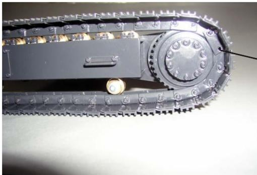
Jetzt können die zwei Enden der Kette mit einem Bolzen und Sicherungsringen verbunden werden.
