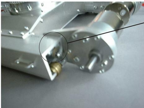
Die Getriebeeinheiten werden mit 4 Schrauben (\*) M3x12 Din 912 und Stopmuttern an den Laufwerksträgern angeschraubt.
