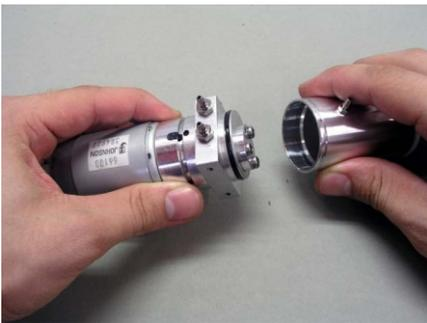
Reinigen Sie den leeren Tank z.B. mit Waschbenzin oder Spiritus.
