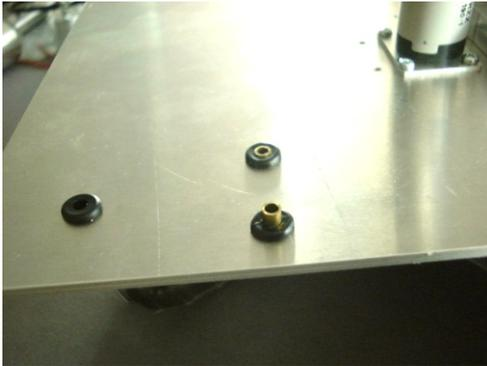
In die mittleren Gummitüllen werden 2 Messing-Röhrchen eingesetzt ( K ).
