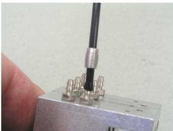
Dann wird der Schlauch bis etwa zur Hälfte auf den Nippel geschoben.
