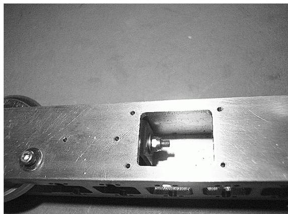
In dem Ausschnitt des Laufwerksträgers sollte jetzt die Mutter der Kettenvorspannung sichtbar sein.
