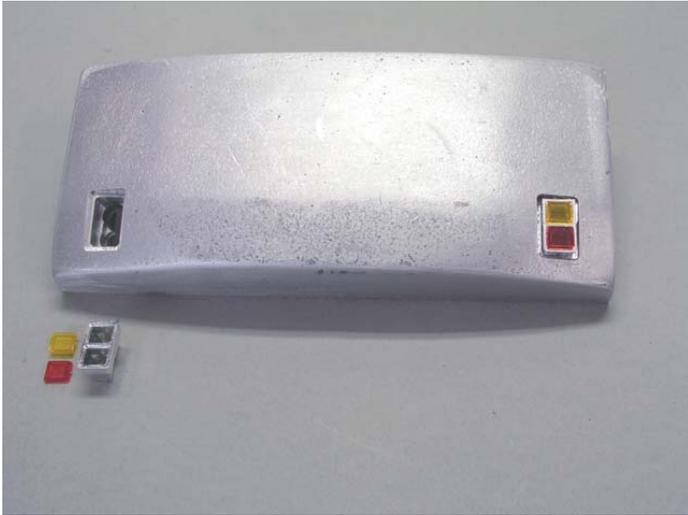
In das Kontergewicht werden die Lampenkörper mit den Lampen gläsern eingesetzt.
