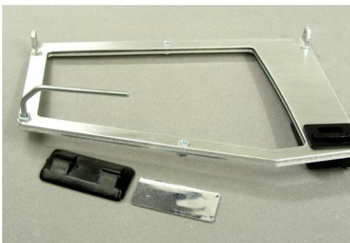
In die obere Bohrung wird der Drahtbügel mit 2 Muttern M2 befestigt . An dem Drahtbügel wird dann der Kunststoffhalter befestigt, in dem dann die Spiegelfolie geklebt wird .
