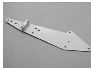
Falls Sie das optionale Schnellkupplungsset erworben haben, müssen jetzt die Schnellkupplungshalter wie in den Bildern ersichtlich an die Seitenteile des 3. Arms geschraubt werden. Nun können auch die Schnellkupplungen mit Madenschrauben DIN913 M3x3 in den Haltern montiert werden.
