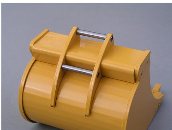
Die aus den Gelenkteilen ausgebauten Bolzen 4x31 werden in die Schaufel eingebaut.
