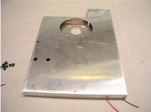
... wird das Oberwagenbodenabdeckblech aufgesetzt und mit 10 Schrauben Din 7380 M3x5 befestigt .
