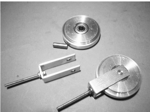
Im vorderen Teil des großen U-Winkels wird das Leitrad mit dem Bolzen 6x18 eingebaut.
