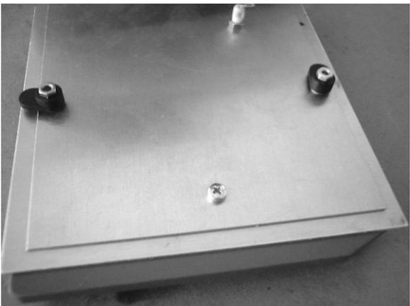
Mit einer Schraube M3\*6 Din 7985 wird die Lufthutze aufden Deckblechen festgeschraubt, oder mit zweiseitigem Klebeband aufgeklebt.
