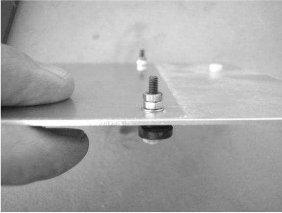
Zur Befestigung werden Madenschrauben Din 913 M3\*10 statt der Gewindegriffe eingesetzt.
